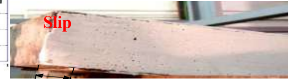
(d) Slip at beam end at the end of test
